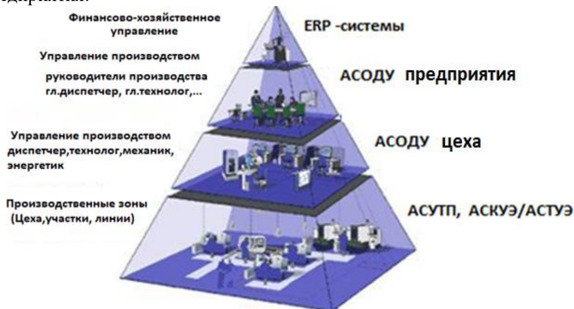
Рис1. Концептуальная иерархическая ЕАСУ- структура цифрового промышленного предприятия
